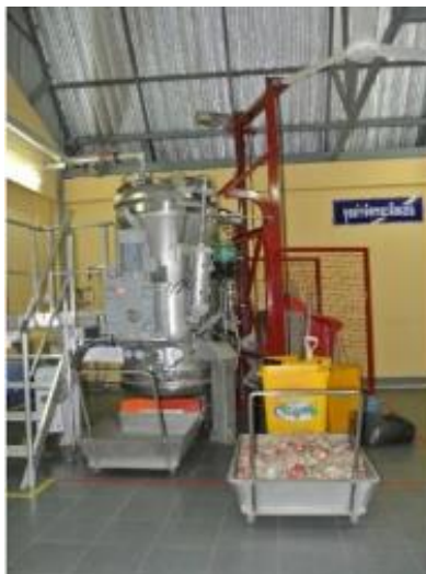
รูปที่ 8 เครื่องทำลายเชื้อด้วยไอน้ำ (Autoclave) โรงพยาบาลลำปาง
