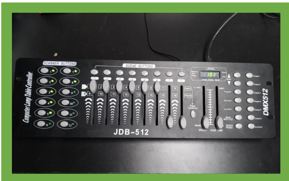
Ligue os bancos de 1 à 5 e em seguida, os canais com as cores que quer. Após isso, acione o Master para que as luzes acendam.
