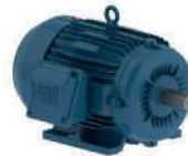
MOTOR 20 HP 4 P 02018ET3EM256TW HP 20 RPM 1800 Armazon 254/6T Alimentación 230/460 vca 3/60Hz
