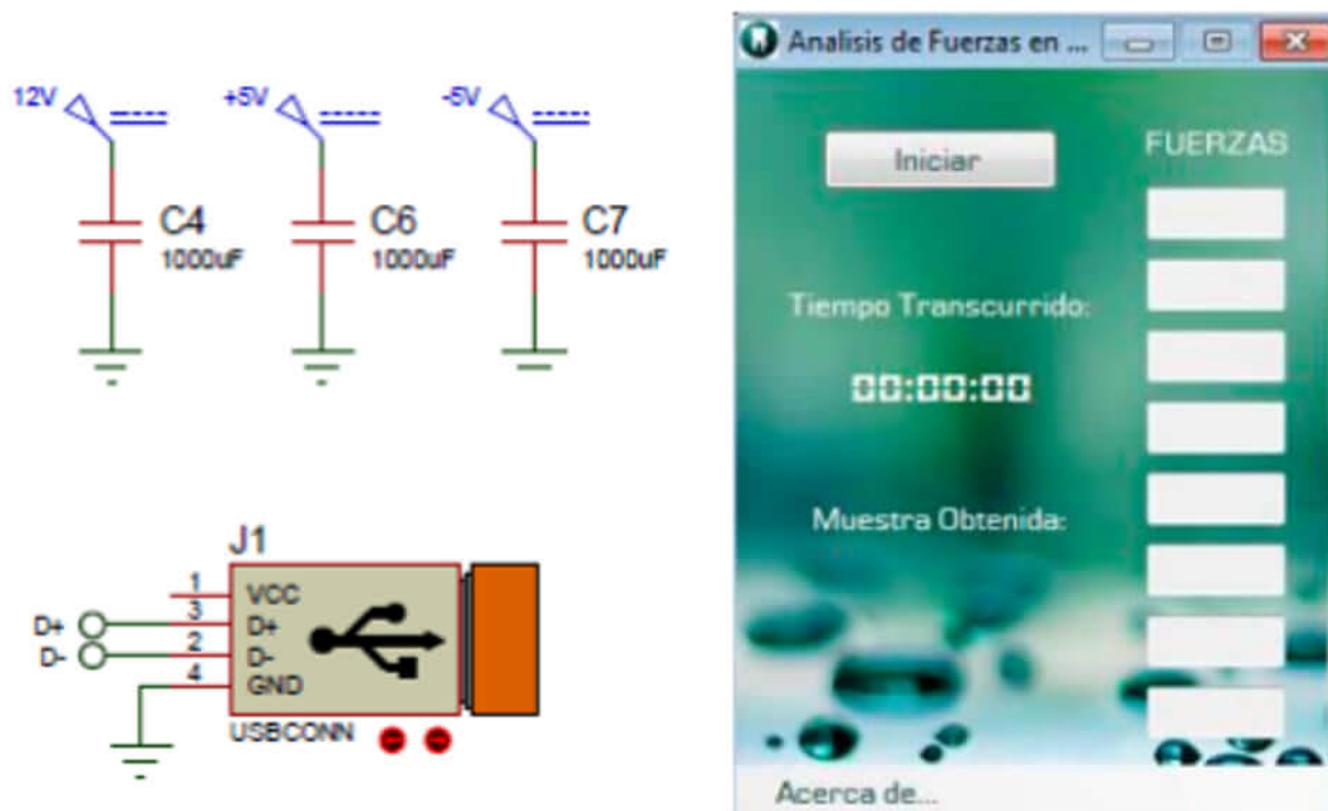
Fig. 8. Software Análisis de Fuerza con conexión USB al ordenador.
