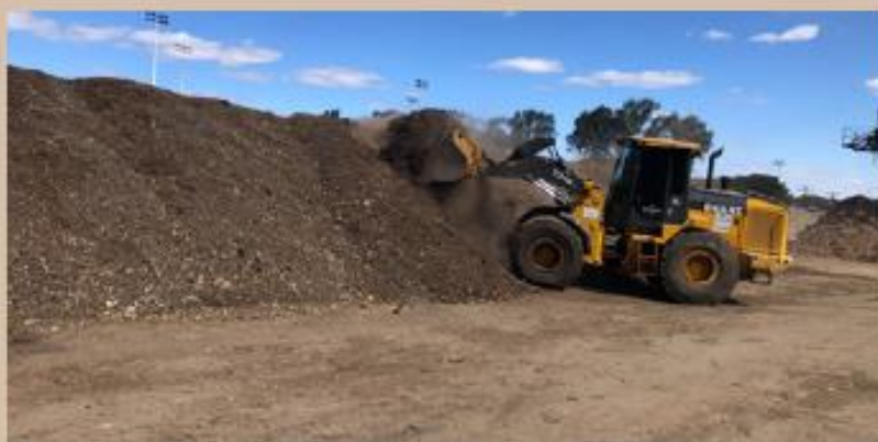
Foto 2 — Processo atual de revolvimento das leiras em Ceilândia, utilizando pá carregadeira
